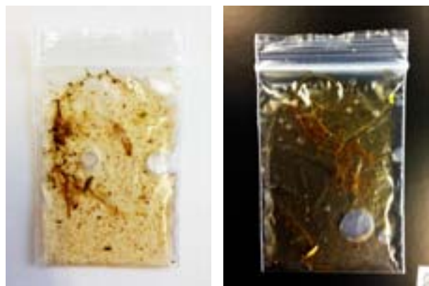
Fig. 8: ビニール袋に入れる。採集した水を、ジッパー付きのビニール袋に入れると、簡単に携帯顕微鏡 (Fig. 7a 参照) や実体顕微鏡 (Fig. 11 参照) で観察できるようになります。(a) は白い台紙の上に置いたもの、(b) は黒い台紙に置いたもの、それぞれ見え方が変わってきます (Fig. 9、Fig. 14 参照)。
