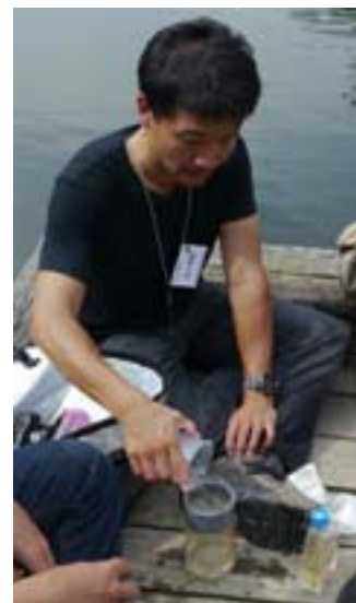
Fig. 6: 濃縮装置。プランクトンネットがなくても、このように、プランクトンネットと同様の細かいメッシュに採集した水を通すことで、メッシュ上にミクロ生物を濃縮することができます。写真は、岩国市立ミクロ生物館 ( http://www.shiokaze-kouen.net/micro/ ) で館内販売している「かんたん！プランクトン濃縮セット」です。
