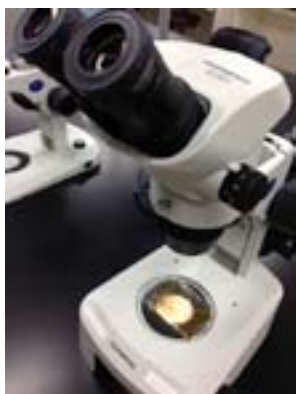
Fig. 11: 照射照明タイプ。下から光を通すように観察します。透明なものが多い微生物は、照射照明タイプの方が見やすいです。
