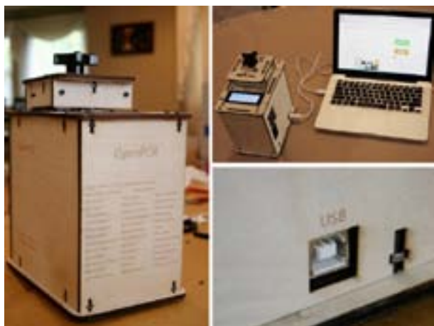
Fig. 1 OpenPCR. 温度制御などは PC で行う。
